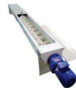
ШНЕК ОТХОДОВ WASTE AUGER
